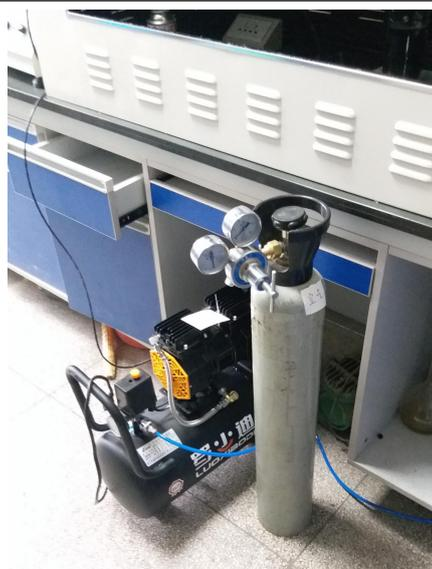
图2. 格致楼 3042 气瓶未固定存在安全隐患 (3月8日检查时拍摄)。
