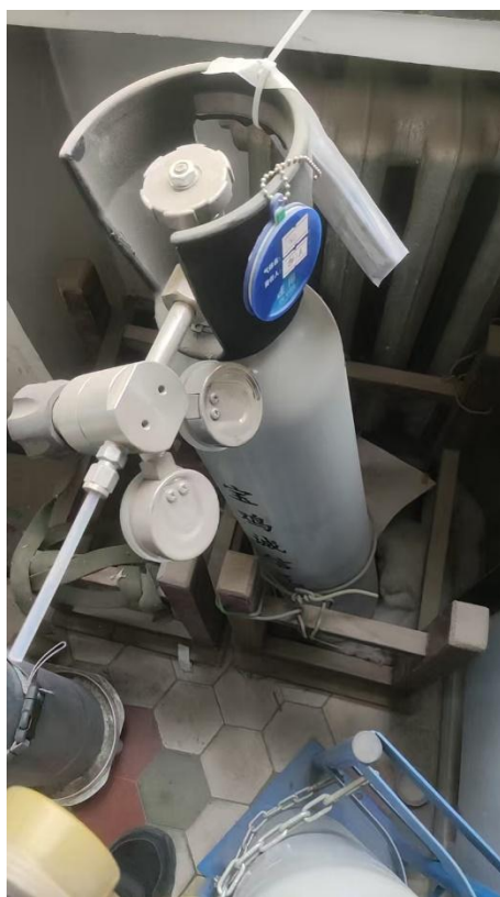
格致楼 2039: 一氧化氮气体没有气瓶架
