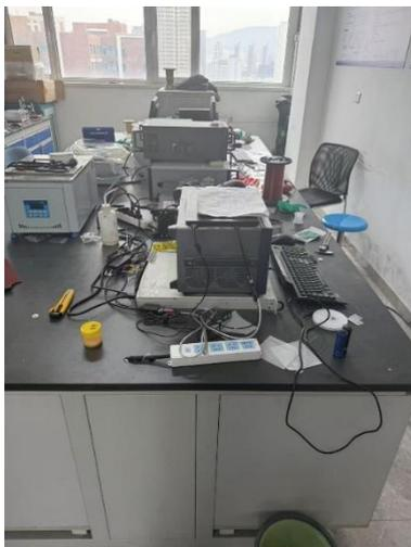
理工楼 1422：插线板放在地上、桌面插头老化有短路风险、试剂瓶为及时处理、手机充电器用完未拔下
