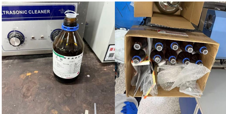
理工楼 102：询问实验室学生无人正在使用的情况下，易制毒药品丙酮未入柜上锁，批量装有废液的试剂瓶未贴标签置于地面
